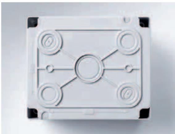
I fondi dei contenitori IP40 e IP55 sono caratterizzati da punti di fissaggio a muro con asole per facilitare la messa in bolla, e da prefrattura centrale per l'ingresso con tubi corrugati diametri 16 e 20 mm.
